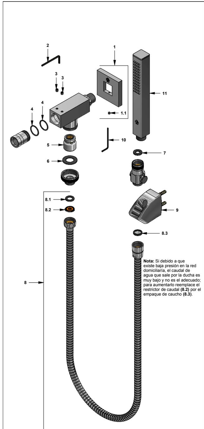
**Nota:** Si debido a que existe baja presión en la red domiciliaria, el caudal de agua que sale por la ducha es muy bajo y no es el adecuado; para aumentarlo reemplace el restrictor de caudal (8.2) por el empaque de caucho (8.3).
