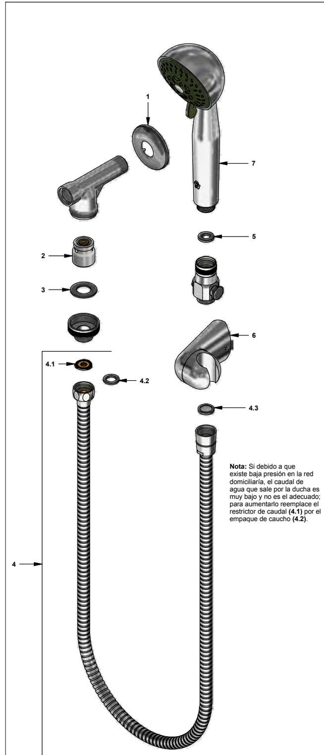
**Nota:** Si debido a que existe baja presión en la red domiciliaria, el caudal de agua que sale por la ducha es muy bajo y no es el adecuado; para aumentarlo reemplace el restrictor de caudal (4.1) por el empaque de caucho (4.2).
